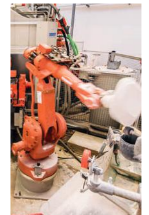
Isostatische Presse mit Putzroboter isostatic press with cleaning robot
